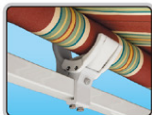
■巻取サポート【特許出願済】 ※巻取サポートはポリエステル系キャンバス使用時での設定を推奨します。 2ピース構造の採用により、取付取外し及びメンテナンスも容易です。抜け出し防止の形状で巻取パイプのたわみ・はずれを防止します。回転ベルトのガイドにより、キャンバスの耐久性を高めています。
