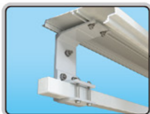
■上ケース用取付ブラケット 上ケースをボルト・ナットで固定します。 ※上ケースはオプションです。
